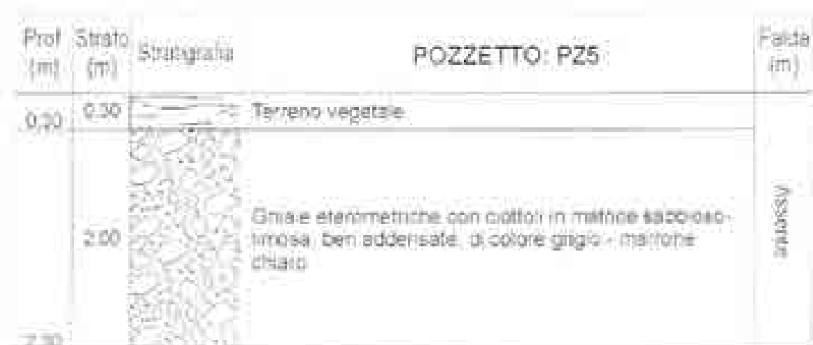
Figura 2 - Stratigrafia dei pozzi esplorati eseguiti nell'area
